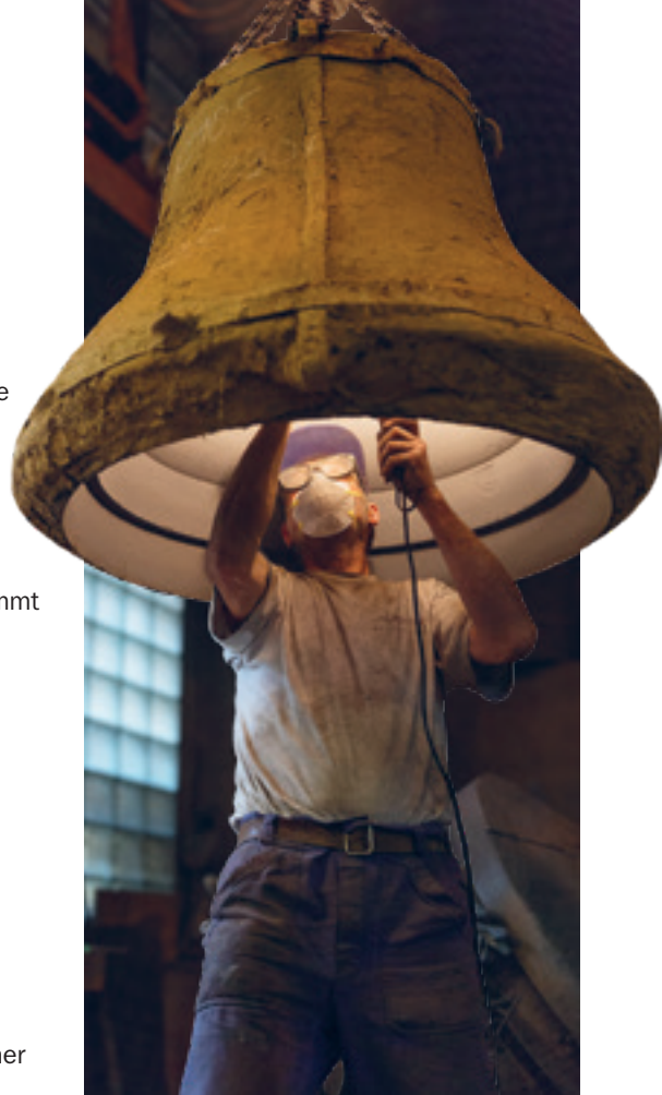
Vor dem Guss der Glocke wird der Mantel, der äussere Teil der Form, noch einmal inspiziert.
